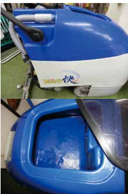
汚水タンクも毎日隅々まで綺麗に洗います
